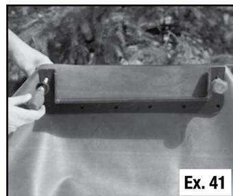
Veillez à ne pas endommager les filets sur les inserts d'écrou quand vous percez les trous à l'aide de l'alène. Retirez l'alène ou le clou tout en maintenant en place le bec de la chute d'eau et la poche et commencez à enfiler une des vis dans le filtre.
